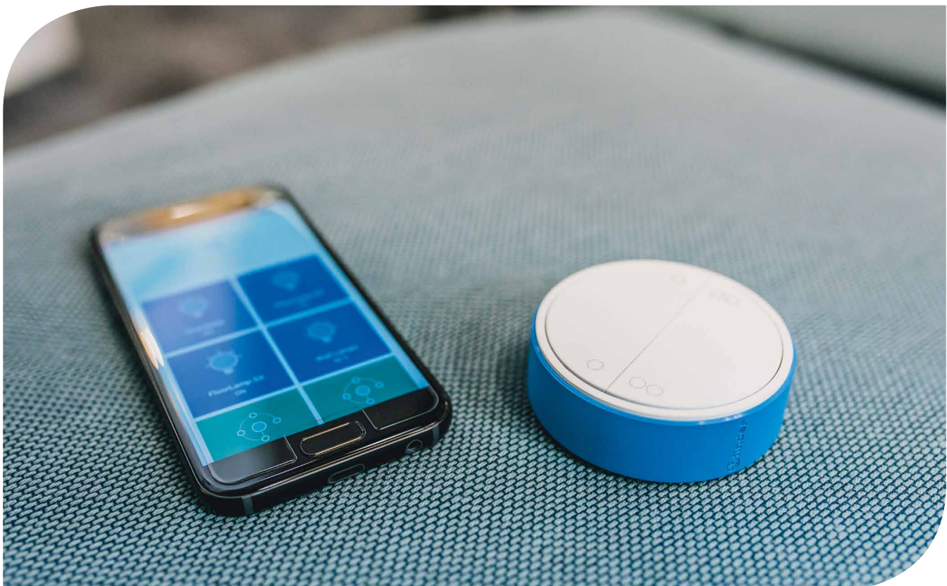
Typ 1Y.13.B12 - przycisk BLE 2 kanały Typ 1Y.13.B22 - przycisk BLE 4 kanały Czarny
